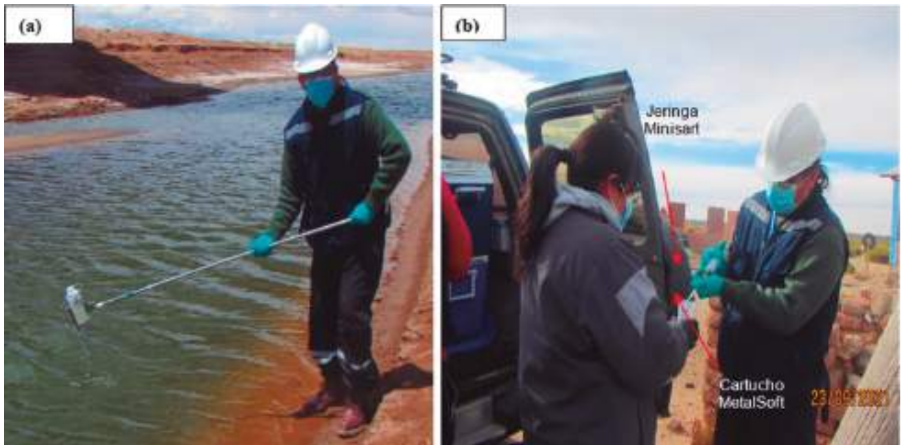
Figura 4.6: Materiales utilizados en el muestreo. (a) brazo muestreador de acero inoxidable y (b) filtros de jeringa Minisart y cartucho MetalSoft de separación de arsenito ( \text{As}^{3+} ) y arsenato ( \text{As}^{5+} ) soluble.
