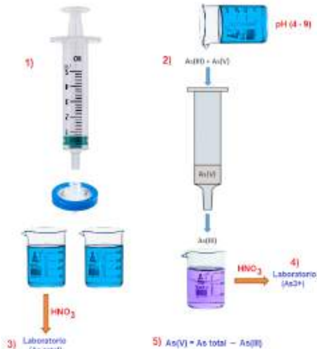
Figura 4.13: Esquema de separación de las especies de arsénico.
