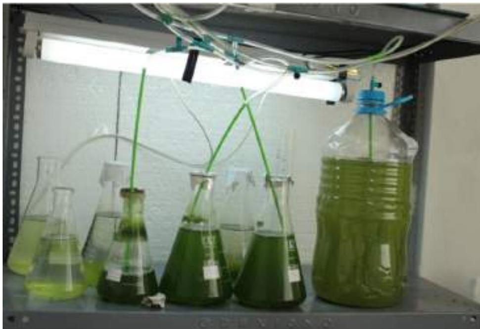
**Figura 3.6:** Cámara de cultivo artesanal en la que se aprecian matraces Erlenmeyer utilizados en la producción de alimento vivo en laboratorio. Fuente: Mamani (2022).
